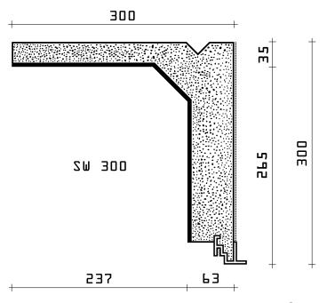
Serienmäßig haben alle Rolladenkästen der Typenreihe SW eine spezielle Clip - Innenschiene für den einfachen, schraublosen EASY - CLIP - Deckelanschluss, mit 15 mm Ausladung.
